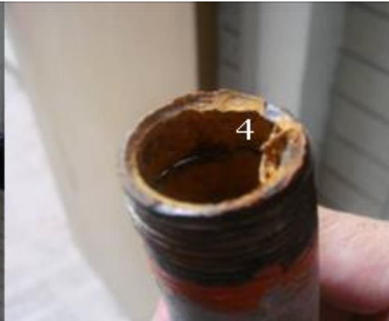
1.冰水管 2.消防管 3.撞擊點 4.受破壞之冰水管
