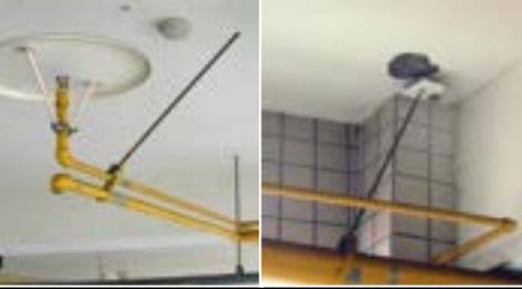
依照埔里停車場管線配置方式，配合振動台實驗屋架尺寸，以兩種不同接頭型式(滾溝接頭及焊接接頭)分別進行振動台實驗。
