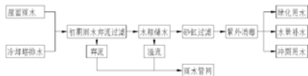
图1 冷却塔排水+雨水收集回用工艺流程
