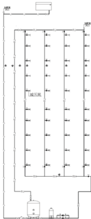
图3 高低区共用水加热器，分户支管设减压阀
