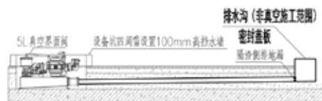
图5 排水沟接入真空界面阀
