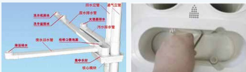
图5 集中水封敞口内部状况一目了然
