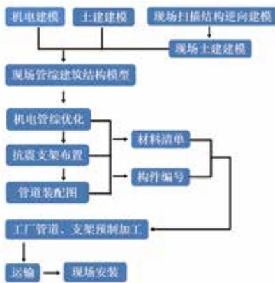
图2 给排水管线装配式安装技术路线
