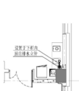
图6 厨房洗涤盆排水管安装示意图一
