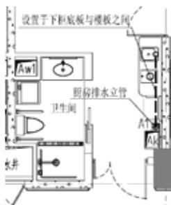
图7 厨房洗涤盆排水管安装示意图二
