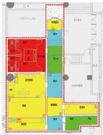
图3 一层隔离区平面图（正常、突发）
