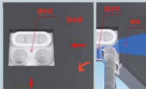
自带泄水孔排除积水 可靠防臭
