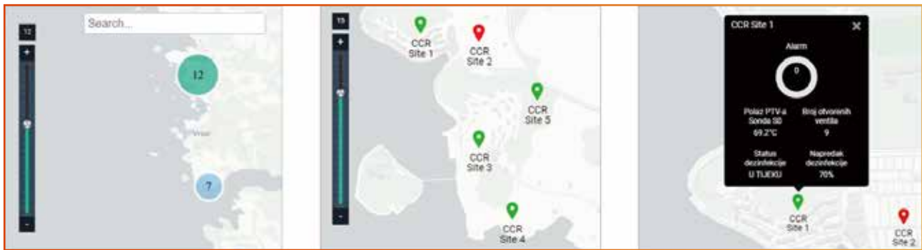
图5 基于云的集中式生活热水控制系统可以显示所有现场位置的情况
