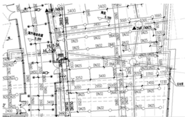
图3 典型走道及大商铺部分内喷头布置
