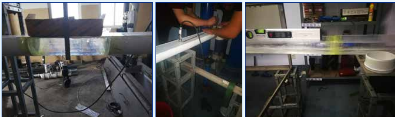
图3 半圆管排水流量、坡度、充满度测试
