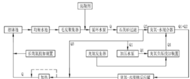
图4 分流量全程式臭氧消毒流程图
