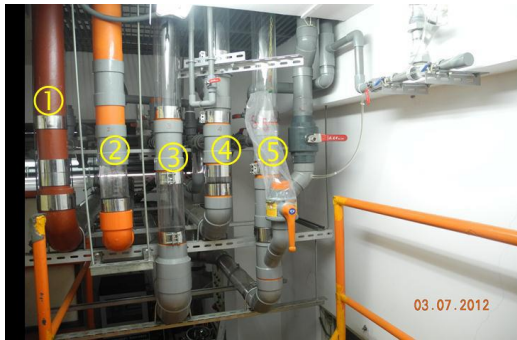
圖 15 排水立管底部正壓現象測試
