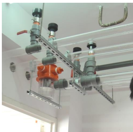
圖 11 排水橫支管負壓現象測試
