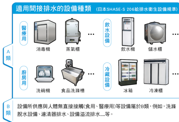
圖 51 應設置間接排水的設備種類
