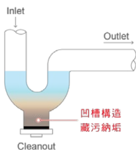
圖 41 單通道存水彎底部清潔口凹陷構造示意例
